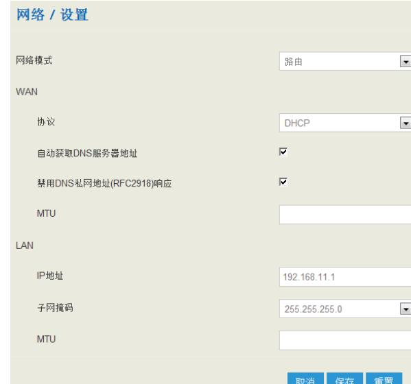
UC100设备的网络模式默认为路由模式，可选择将其设置为桥接模式。路由模式下，WAN口的IP地址与LAN口的IP地址需在不同网段，WAN口的默认IP地址获取方式为DHCP，而LAN口的默认IP地址为192.168.11.1。桥接模式下，WAN口与LAN口共用同一个IP地址。
