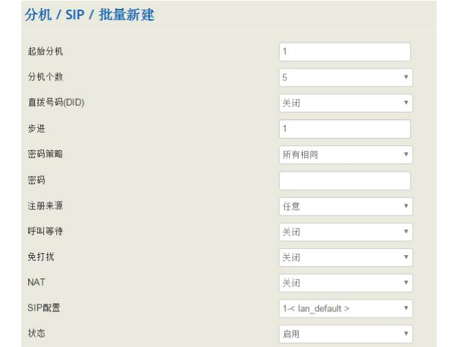
若新建成的SIP分机账户的状态为“启用”，则表示本台UC100设备接受该分机账户的注册；若SIP分机账户的状态为“禁用”，则表示本台UC100设备拒绝该分机账户的注册。最多可配置32个SIP分机账户。
