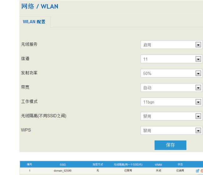
设备默认的SSID为“domain\_[MAC地址后六位]”，如上图的“domain\_6250f0”。除了默认的SSID，用户还可以另外创建三个SSID。
